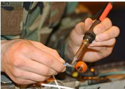
Manuelles Weichlöten mittels eines elektrischen LötKolbens
